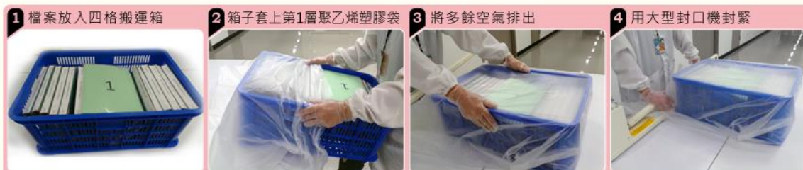
圖10 檔案放入四格搬運箱→箱子套上第1層聚乙烯塑膠袋→將多餘空氣排出→用大型封口機封緊
